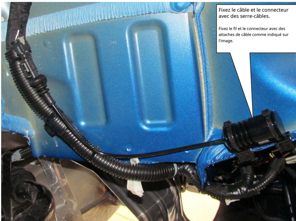
Fixez le câble et le connecteur avec des serre-câbles.
