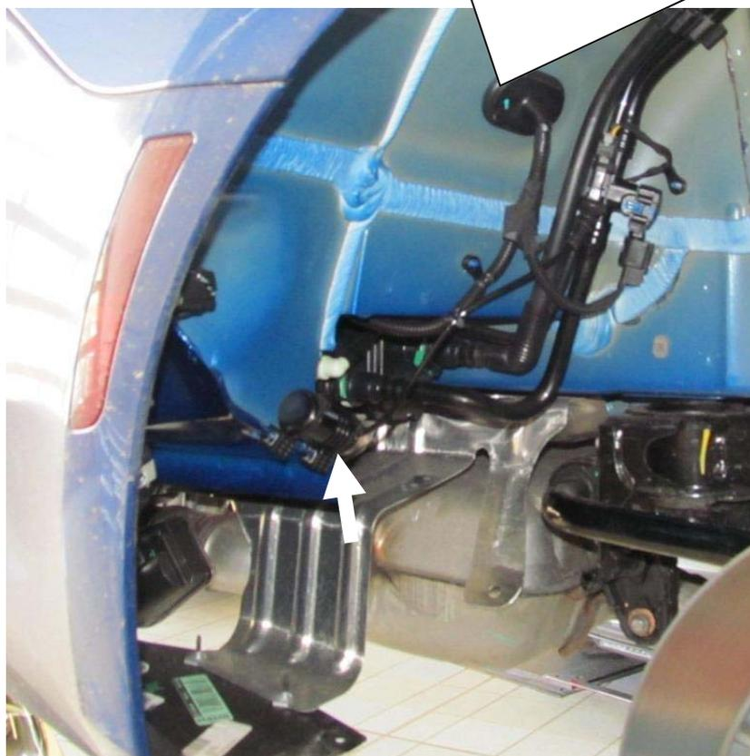
Fixez le câble et le connecteur avec des serre-câbles.
