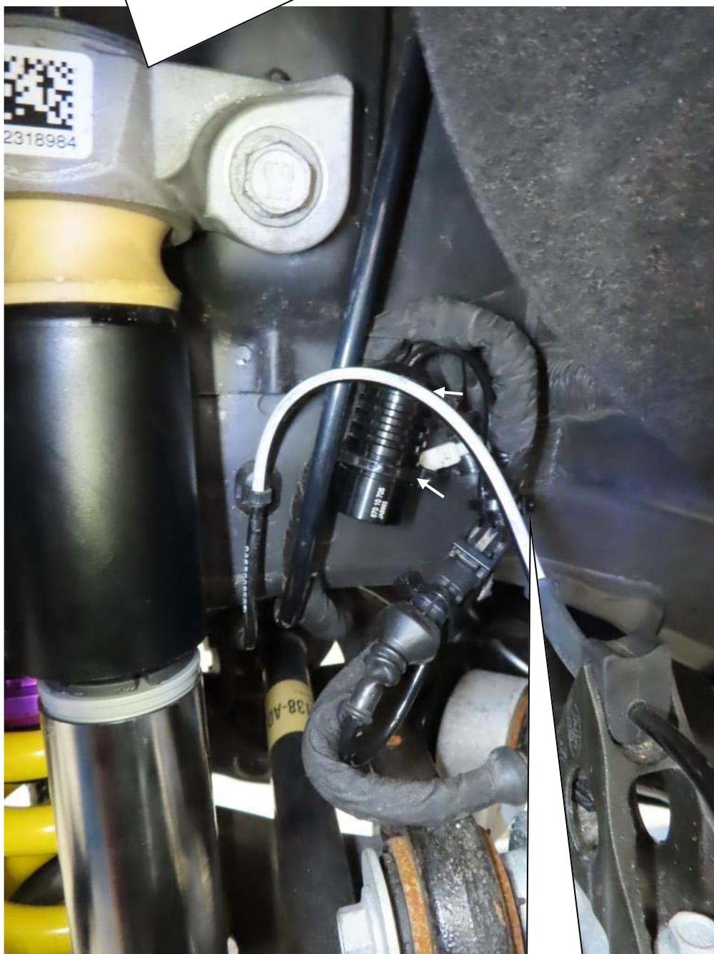
Fixez le câble et le connecteur avec des serre-câbles.
