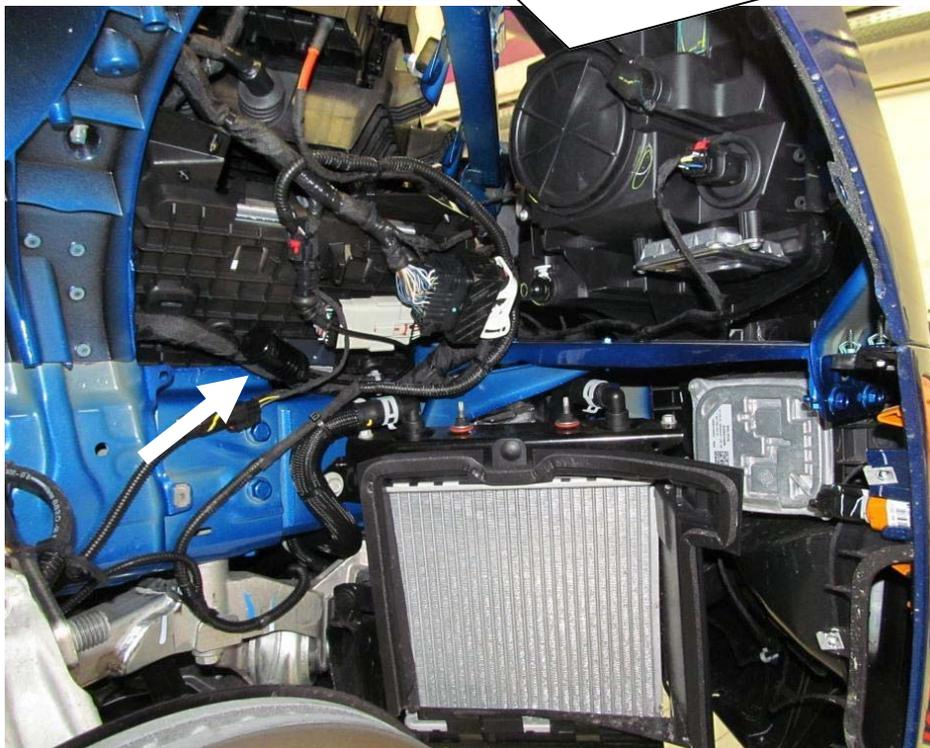
Fixez le câble et le connecteur avec des serre-câbles.
