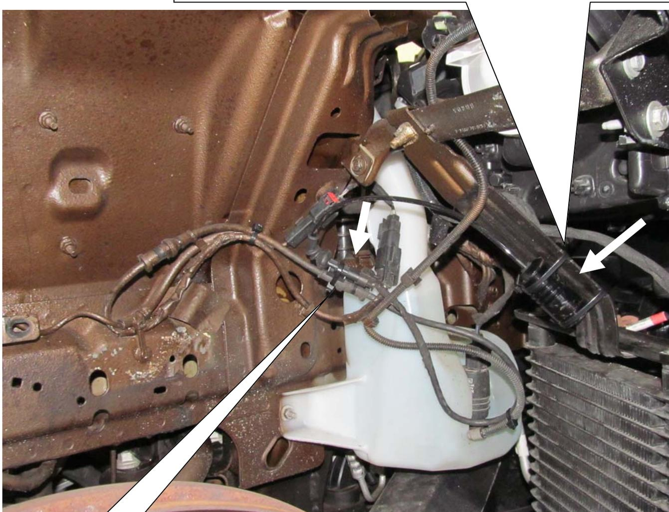
Fixez le câble et le connecteur avec des serre-câbles.
